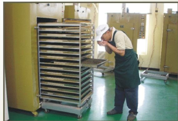
圖 5-29 電熱箱型-焙茶機(林獻堂提供)
